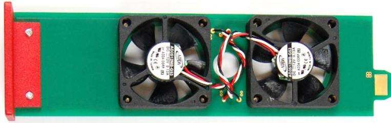
Figure 2 – Left side fan module (fan 3 & 4)
